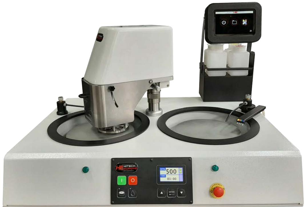
La TSP322KA è una pulitrice automatica a doppio piatto di ultima generazione studiata per produrre campioni metallografici di elevata qualità ad un prezzo competitivo. Il design innovativo abbinato alla base in rigida fusione di alluminio e alla cover in materiale antiurto e anticorrosione, ne garantiscono la stabilità e ne potenziano le funzionalità.
